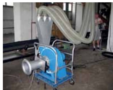
Рис. 2. Обработка озono-воздушной смесью с использованием МОК
